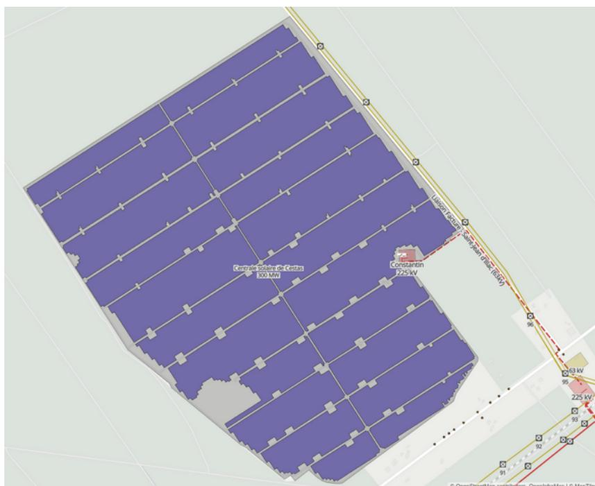
La centrale solaire de Cestas s'étend sur 260 hectares dans le département de la Gironde dans le Sud-Ouest. Disposant d'une capacité de 300 MWc, elle est raccordée au réseau de transport en un unique point dans le poste 225 kV de Constantin.
